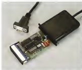
L'interfaccia di conversione seriale/parallela presente nel computer del corso per lo studente è un esempio dell'elevato livello di soluzione degli ingegneri del circuito elettronico.
